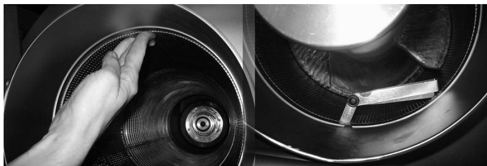
Fig.13-13: Tamis flottant dans le séparateur, vérification manuelle (à gauche)
