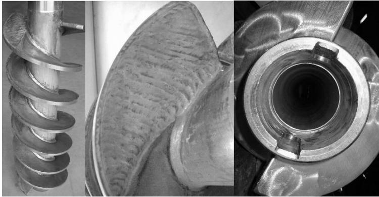
Fig. 13-14: Vis sans fin à blindage spécial et trou de moyeu, état neuf
