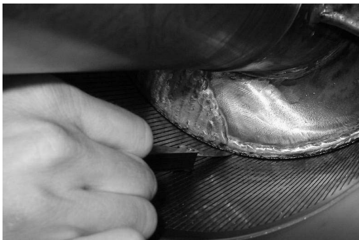
Fig. 13-17 : Mesure de l'écartement de travail entre tamis et vis sans fin ; la mesure est effectuée sur le dessous du tamis à l'arrêt de la machine. La mesure indique le double de l'écartement de travail car le tamis à l'arrêt repose sur le haut de la vis sans fin.
