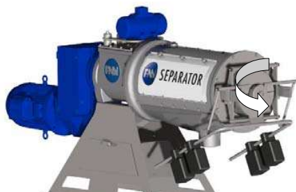
Fig. 5-1 Sens de rotation de la vis sans fin
